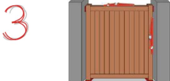
Mettre d'aplomb le vantail, puis le régler (régler les jeux du pilier à l'aide de cales de 25mm).
