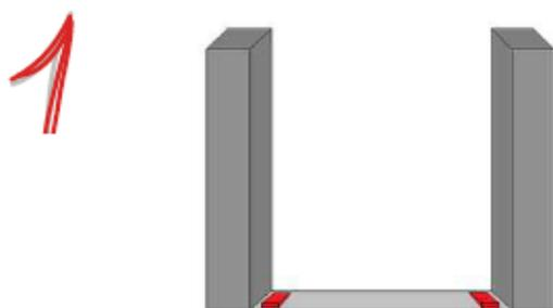
Mettre en place des cales dessous, laisser un jeu de min 25mm. Au sol, tracer la ligne des battants (faire attention que le portail ne touche pas le sol en position ouverte).
