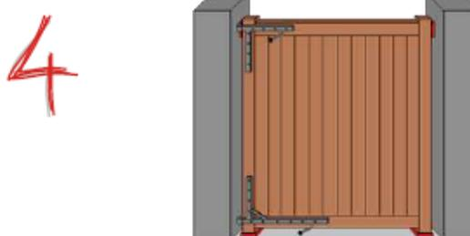
Pré-monter les pentures (avec 3 vis de préfixation PAR penture). N.B : la petite en haut et la grande en bas.
