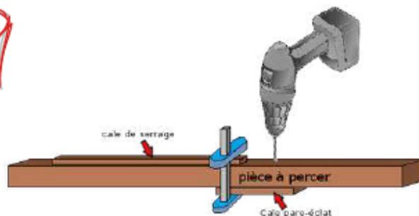
Percer avec un pare-éclat et boulonner les pentures.
