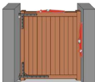
Repositionner le vantail, réajuster les pentures dans le gond et reconstrôler l'aplomb du vantail
